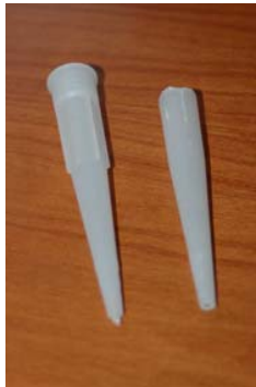
foto 1 a sinistra la cannuccia che trovate in ferramenta, a destra dopo l'intervento per renderla un efficace e rapido strumento per l'inserimento degli anelli colorati
